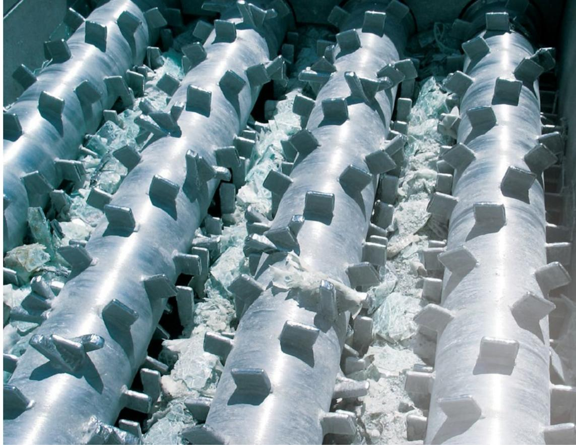
Abbildung 7: Walzenbrecher für Flachglas-Laminatglas. Quelle: ZIPPE Industrieanlagen GmbH
