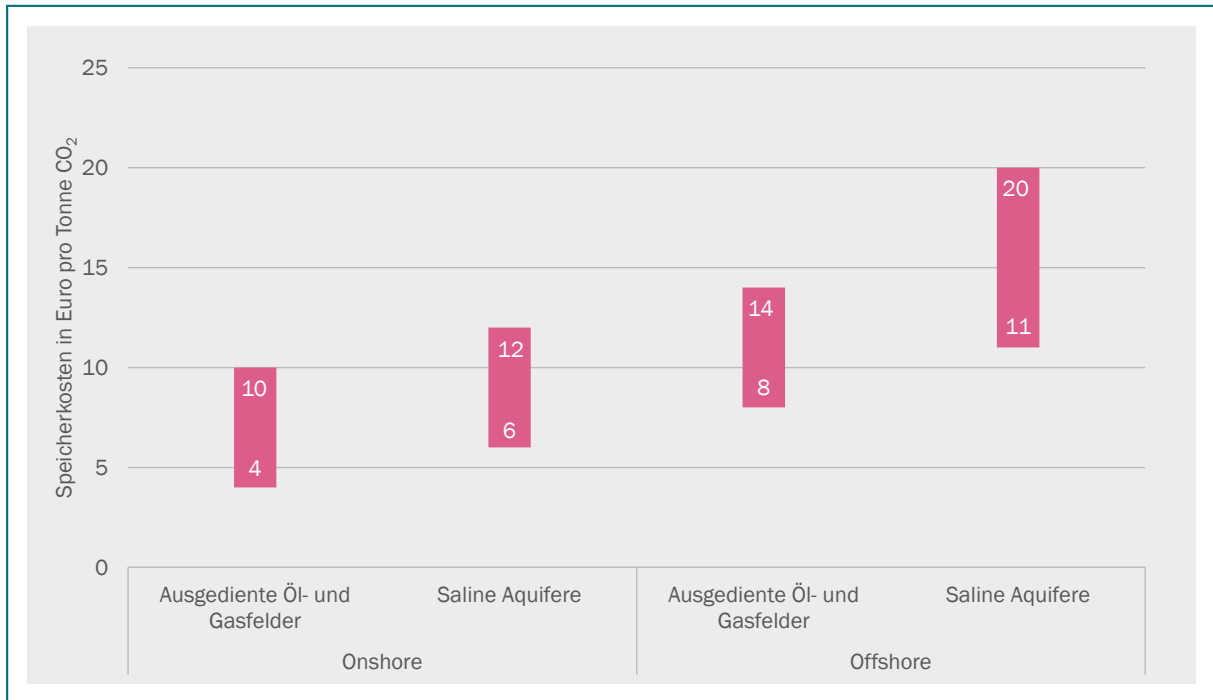
Abbildung 29 CO 2 -Speicherkosten bei einer Kapazität von 1 Mt CO 2 pro Jahr in 2.500 bis 5.000 Meter Tiefe © Prognos AG 2021 Quellen: (Navigant, 2019) (Zero emissions platform, 2011) (Hendriks, Graus, & van Bergen, 2004)
